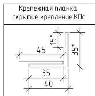
\* – размеры фасонных элементов и оконных кронштейнов следует уточнять по ситуации.
